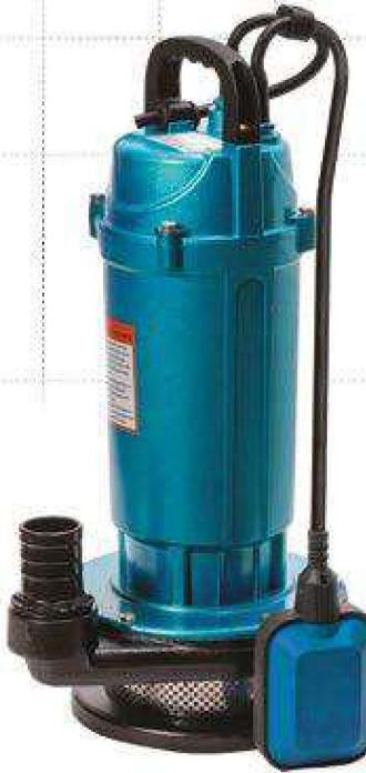
Ponořitelná čerpadla určená k čerpání čisté a lehce znečištěné vody. Kryt motoru je vyroben z hliníku a samotný motor je vybaven tepelnou ochranou namontovanou do vinutí. Specifickou vlastností čerpadel řady WQX je vysoký tlak. Práce čerpadel je ovládána pomocí plovákového spínače. Čerpadla WQX 250 jsou dostupná v provedení s plovákovým spínačem a bez.
