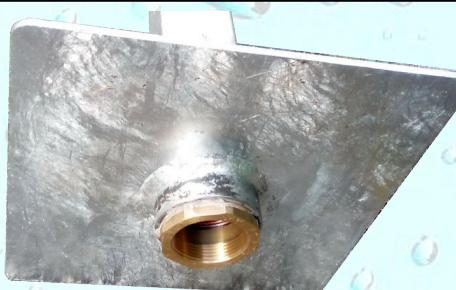
Připojení potrubí je provedeno přes mosaznou redukci 2"x6/4", která je našroubovaná do "vevařeného" nerezového nátrubku 2". Díky tomu se dá potrubí od stojanu snadno oddělit i po mnoha letech. V případě poškození se dá redukce snadno vyměnit.
