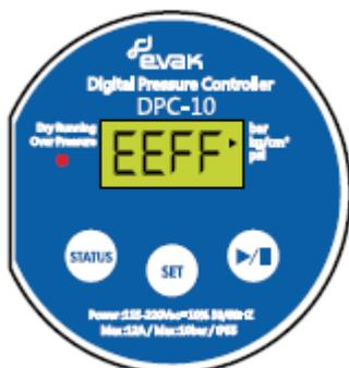
Zobrazení „EEFF“ znamená poruchu jak tlakového tak teplotního snímače – kontaktujte dodavatele
