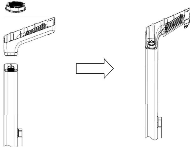
5. Nainstalujte vodovodní trubku, nasaděte zajišťovací kroužek a utáhněte jej šroubovákem.
