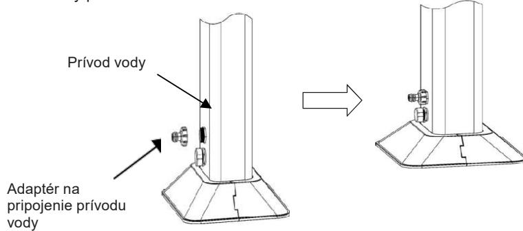
11. Pripravte hadicu s uzavretým prívodom vody a pripojte ju k adaptéru na pripojenie prívodu vody.
