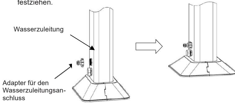
11. Den Schlauch mit der geschlossenen Wasserzuleitung vorbereiten und ihn an den Adapter für den Wasserzuleitungsanschluss anschließen.
