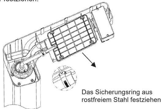
6. Zuerst zwei Konnektoren des Solarpanels und das Konnektor der Batterie in die Steckdose einschieben und dann die Abdeckung des Duschkopfs auf den Kopf installieren.
