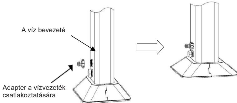
11. Készítse elő a tömlőt a lezárt vízvezetékkel, és csatlakoztassa a vízvezeték csatlakoztatására szolgáló adapterhez.
