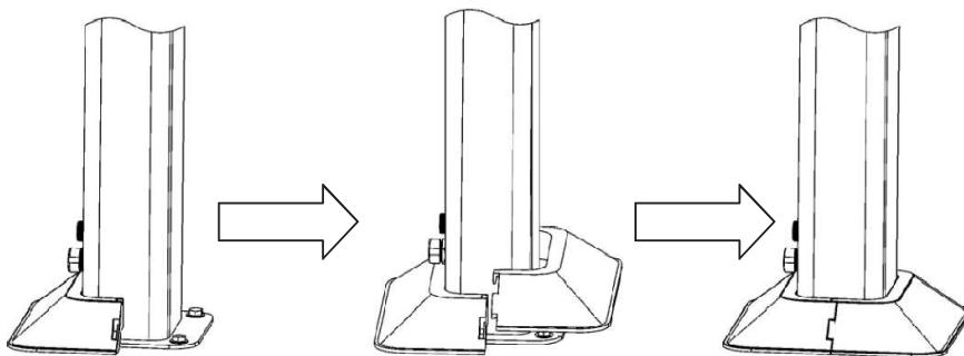
Zamocuj tylną osłonę do podstawki korpusu prysznica, jak jest wyobrażone na rysunku.
