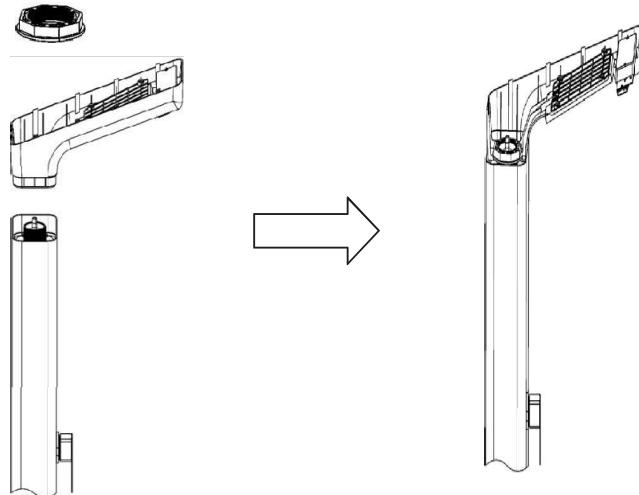
5. Zainstaluj rurę wodociągową, załóż pierścień zabezpieczający i dokrć go śrubokrętem.
