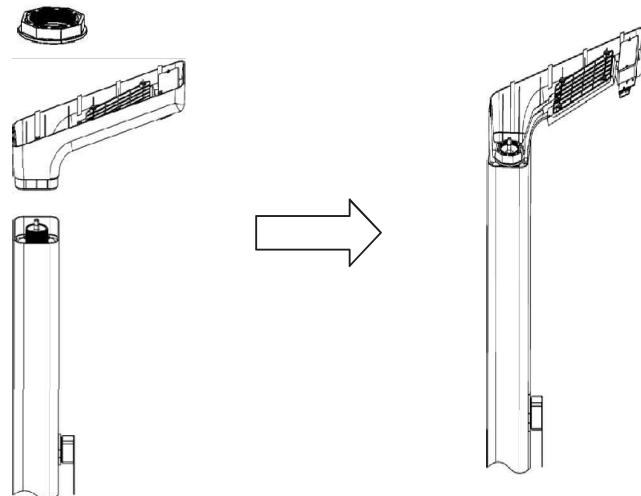
5. Nainštalujte vodovodnú rúrku, nasadťte zaistovací krúžok a utiahnite ho skrutkovačom.
