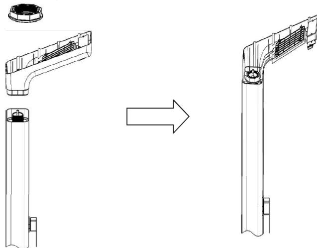
5. Das Wasserrohr installieren, das Sicherungsring aufsetzen und mit einem Schraubenzieher festziehen.
