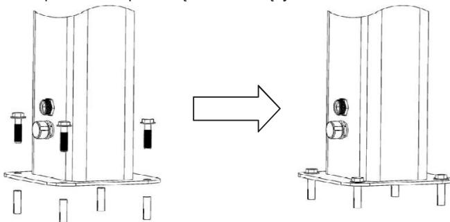
9. Zainstaluj podstawkę dwuczęściową.
