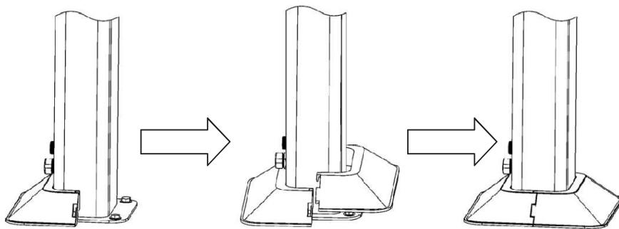
Rögzítse a hátsó borítást a zuhanytest alapzatához az ábrán látható módon.
